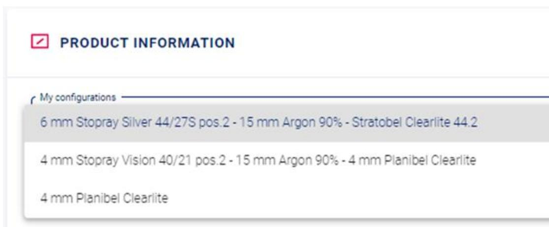
Pour chaque produit verrier choisi, vous pouvez ensuite spécifier les caractéristiques **Thermal Treatment** [Traitement thermique], **Type of Edge** [Type de bord] et **Surface Treatment** [Traitement de surface]. Pour les verres soutenus sur deux ou trois côtés, la finition des bords des panneaux a une incidence sur la résistance.
